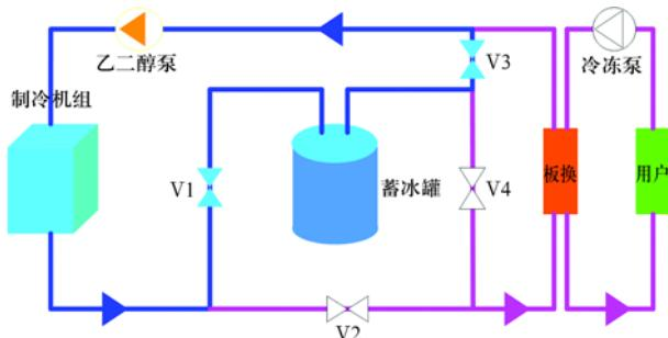
**制冷机、蓄冰罐联合供冷工况** 为了满足空调高峰时期的用冷量，乙二醇溶液经过两次降温，即乙二醇溶液先经过制冷机进行一次降温，然后经过蓄冰罐进行二次降温。为了控制进入板换的乙二醇溶液温度，调节V2、V1阀来达到目的。
