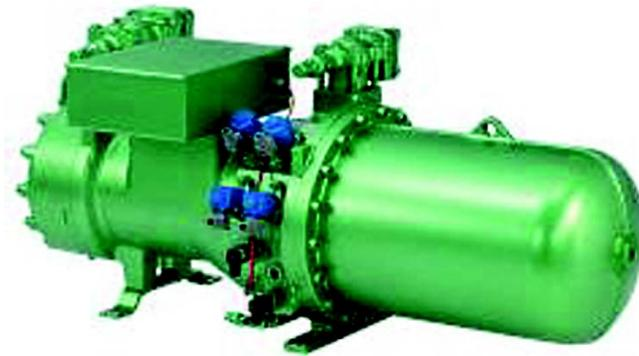
螺杆式压缩机又称螺杆压缩机，分为单螺杆式压缩机及双螺杆式压缩机，双螺杆式压缩机最早由德国人H.Krigar在1878年提出，直到1934年瑞典皇家理工学院A.Lysholm才奠定了螺杆式压缩机SRM技术，并开始在工业上应用，取得了迅速的发展。20世纪50年代，就有喷油螺杆式压缩机应用在制冷装置上，由于其结构简单，易损件少，能在大的压力差或压力比的工况下运行，排气温度低，对制冷剂中含有大量的润滑油（常称为湿行程）不敏感，有良好的输气量调节性，很快占据了大容量往复式压缩机的使用范围，而且不断地向中等容量范围延伸。
