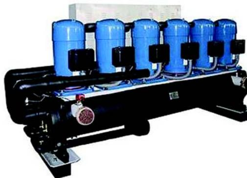
**➤故障运行功能** 主机系统分为三个氟路系统，如果一个氟路系统出现问题，可以在开机状态下通过其它氟路系统运行，保证整个系统的连续运行。如果某个氟路系统中的某台压缩机出现故障，可以只停该压缩机的运行，保证该氟系统的运行。
